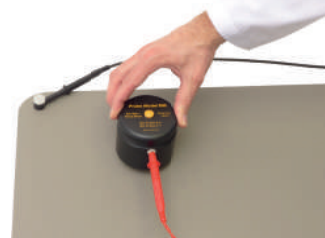
Przykład zastosowania: Pomiar z użyciem elektrody cylindrycznej
