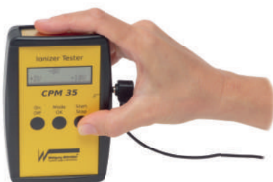
Przykład zastosowania: prosty pomiar Walking Test
